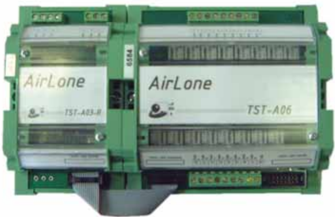
Exemple d'association d'une TST-A03-R avec une TST-A06
