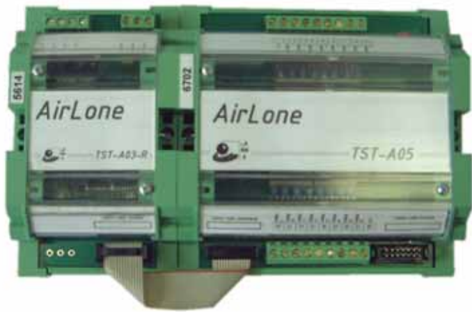
Exemple d'association d'une TST-A03-R avec une TST-A05
